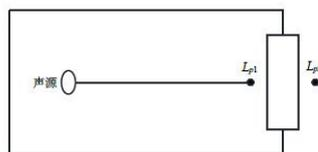
(II) 计算出所有室内声源在靠近围护结构处产生的总倍频带声压级：
